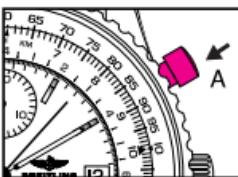
2. Para interromper a medição, volte a pressionar o pistão A. Para retomar a medição, pressione o pistão A. Desta modo é possível acumular a medição de vários tempos curtos.
