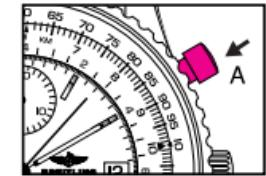
2. Interromper a medição pressionando novamente o pistão A. A medição é efectuada em horas (contador 1), minutos (contador 2), em segundos e em  $\frac{1}{4}$  de segundo (ponteiro 3).
