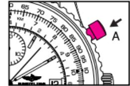
2. Fermare la misurazione premendo di nuovo il pulsante A. La misura si effettua in ore (totalizzatore 1), in minuti (totalizzatore 2), in secondi e in quarti di secondo (lancetta 3).
