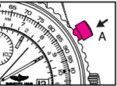
2. Для остановки хронографа еще раз нажмите на кнопку **A**. Показания об измеряемом отрезке времени можно прочитать: в часах (счетчик **1**), минутах (счетчик **2**), в секундах и в  $\frac{1}{4}$  доли секунды (стрелка **3**).
