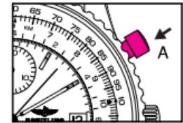
2. クロノグラフを停止させるには、もう一度ボタンAを押します。経過時間は、時（1）、分（2）、1/4秒（指針3）単位で測定できます。
